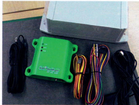
LostnFound-System, der graue Kasten im Hintergrund ist das IP67-Gehäuse.
